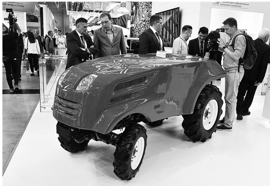
НПО автоматики представила прототип беспилотного трактора. На нем отсутствуют привычные органы управления – здесь нет кабины, руля и педалей. «Глазами» трактора служат камеры с функцией точного вождения – машинное зрение определяет препятствия и строит траекторию движения сельхозтехники.
