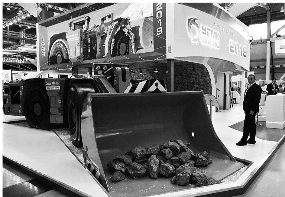
Одним из главных экспонатов стенда УГМК стал шахтный погрузчик грузоподъемностью 10 тонн. Техника работает в экстремальных условиях — на уровнях больше пятисот метров под землей. Погрузчик оснастили проверенной трансмиссией, гидравликой, индикаторами состояния машины и системой пожаротушения.
